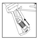
3. Holen Sie das XLR-Kabel aus dem Handgriff, indem Sie es hochschieben und bei Bedarf durch den Handgriff schieben.
