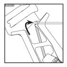
4. Arretieren Sie das Kabel mit dem Clip an der Oberseite des Handgriffs.
