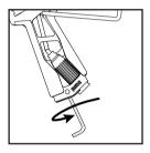
2. Verwenden Sie einen 3mm-Inbusschlüssel, um die XLR-Klemme (mit dem Gewindeadapter) zu öffnen.
