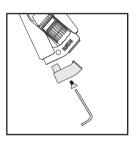
3. Arretieren Sie das XLR-Kabel mit dem XLR/ Galgenmastadapter, dessen Schraube mit Hilfe eines 3mm-Inbusschlüssels angebracht werden muss.
