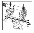
Halten Sie das Mikrofon über die Lyre-Clips und drücken Sie es behutsam in die Clips. Überprüfen Sie anschließend, ob es richtig festsitzt.
