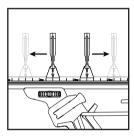
2. Halten Sie den Sockel des Lyre-Clips und die Schiene fest, während Sie den Clip zur geeigneten Position schieben.
