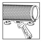
2. Lösen Sie den front- und rückseitigen Klemmhebel um ca. 1~2 Umdrehungen.
