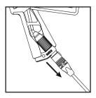
1. Um das Blimp-Profilkabel entfernen zu können, müssen Sie zunächst seine Verbindung mit dem externen Kabel lösen.
