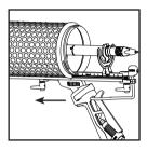
6. Sorgen Sie dafür, dass die Schienen richtig in das Blimp-Gehäuse gleiten können und schieben Sie die Aufhängung wieder in das Blimp-Gehäuse.
