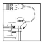
5. Wenn Sie das Blimp-Profikabel verwenden, kann es mit der Kabelhülse am hinteren Ende der Schienen arretiert werden: Der Stecker muss wie in der Abbildung gezeigt angeschlossen werden.
