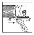
3. Schieben Sie die Aufhängungseinheit aus dem Blimp-Gehäuse.
