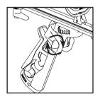
2. Drehen Sie die Winkelklemmschraube auf der rechten Griffseite an, um die Spannung des Schnellspanners zu erhöhen.
