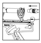
6. Verbinden Sie das Kabel mit dem Mikrofon und stellen Sie die Handgriffneigung wunschgemäß ein.
