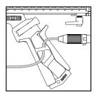
1. Schieben Sie das Kabel so in den Handgriff, dass es wie in der Abbildung gezeigt verläuft.
