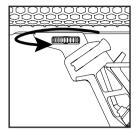
1. Um den Handgriff zu verschieben, müssen Sie zunächst die Klemmschraube an der linken Griffseite lösen.
