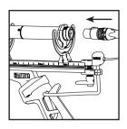
5. Verbinden Sie das Blimp-Kabel mit der XLR-Buchse des Mikrofons.
