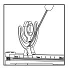
Für bestimmte Mikrofontypen muss man die Lyre-Clips entlang der Schienen etwas weiter nach vorne bzw. hinten schieben. Nachstehend wird erklärt, wie man die Lyre-Clips richtig einstellt.
