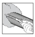
Schieben Sie die Blimp-Vorderseite so in den Fellschutz, dass sich dessen Saum in der Nähe der Schienen an der Blimp-Unterseite befindet.
